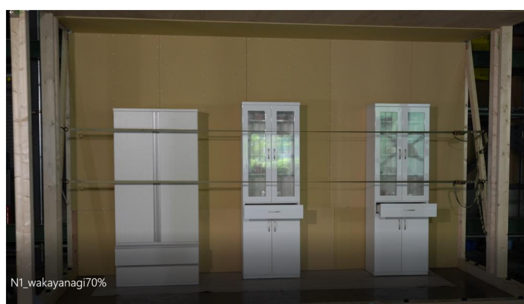
震度6弱の加振後の様子 (写真16) 左 試験体(ア) 中央 試験体(ア) 右 試験体(イ)
