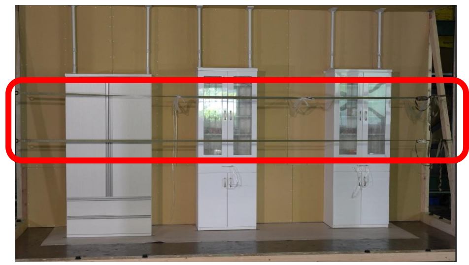
保護ベルトを取り付けている様子 (写真3)
