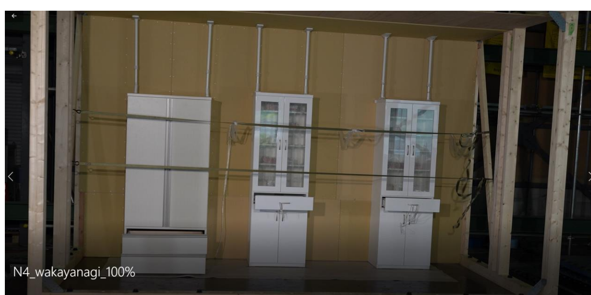
震度6強の加振後の様子 (写真15) 左 試験体(ウ) 中央 試験体(ウ) 右 試験体(エ)
