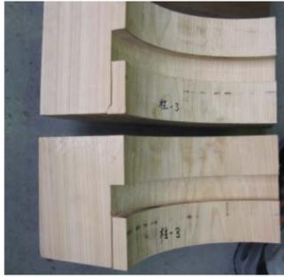
(a) 補強部材のせん断割裂
