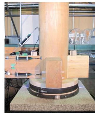
写真 3 補強の取り付け状況
