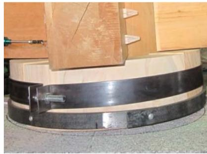
(b) 補強部材のずれ
