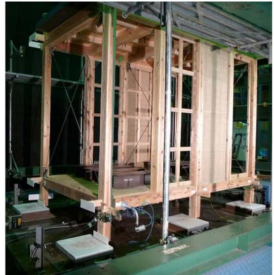
図2 6本柱の軸組試験体（9月）
