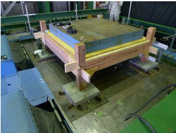
図1 4本柱・柱脚部だけの試験体（7月）
