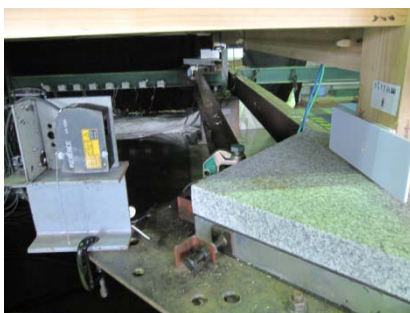
(1) 柱脚すべりの計測
