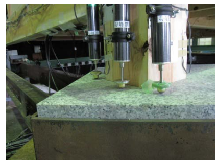
(3) 柱脚浮き上がりの計測
