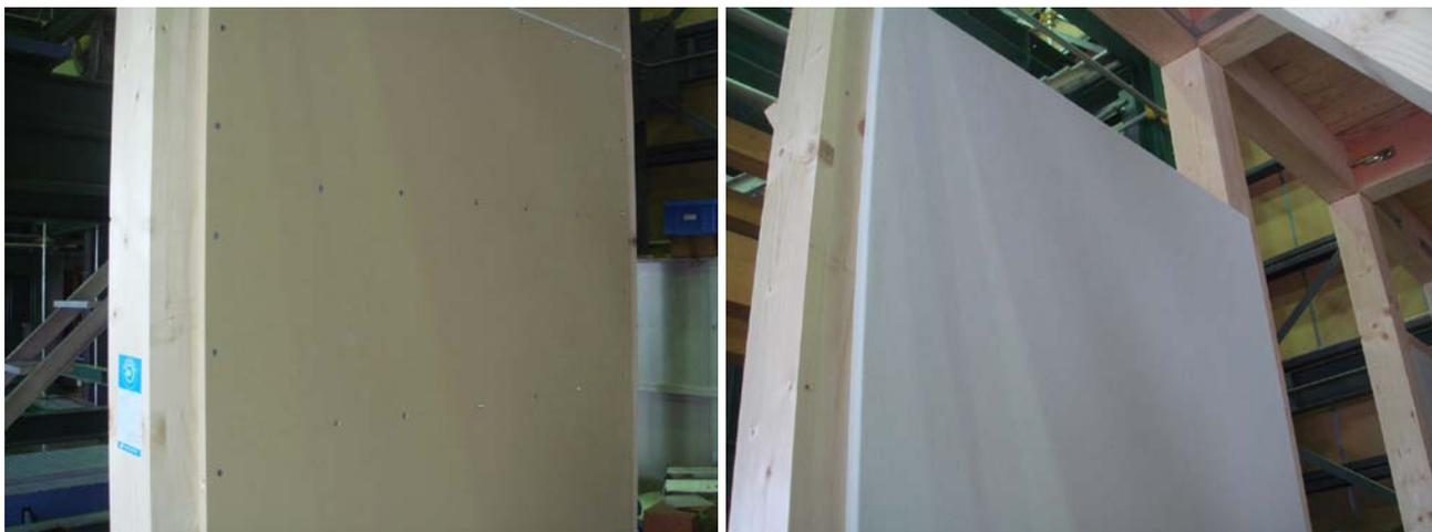
（実験後） クロスの一部に割れが発生したが、壁自身の損傷はなかった。
