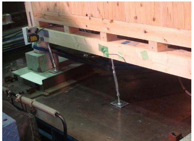
鋼製束の損傷はあったが、束石からずれ落ちることなく、また壁柱自身も損傷はなかった。
