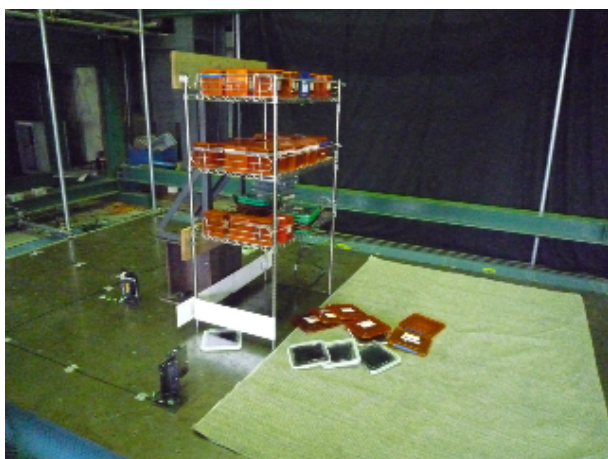
写真3 非免震試験体 80%実験後
