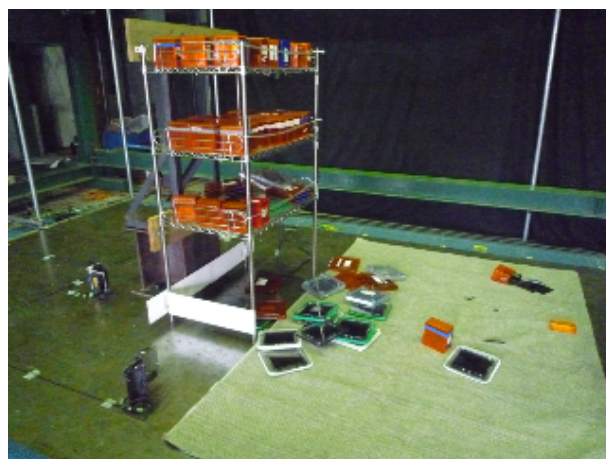
写真4 非免震試験体 100%実験後
