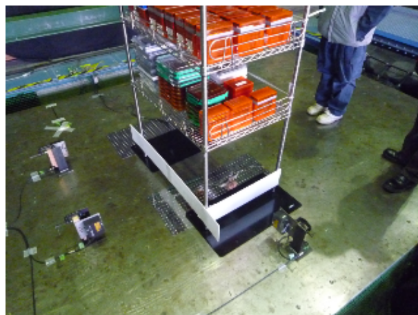
写真2 免震試験体実験後
