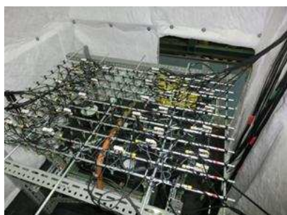
タンク上への音源探査用 マイクロホン165ch設置状態
