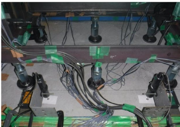
図6 各種センサー類取付状況
