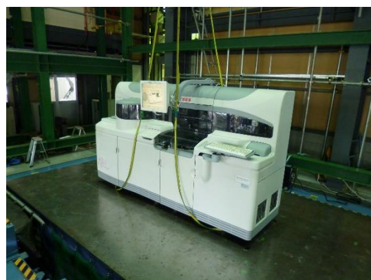
写真2 非免震試験体
