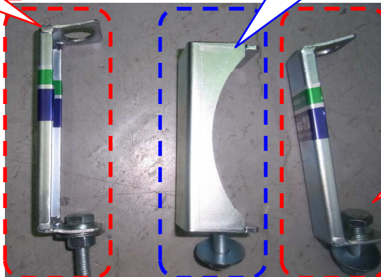
加振実験後の防振ハンガー比較
