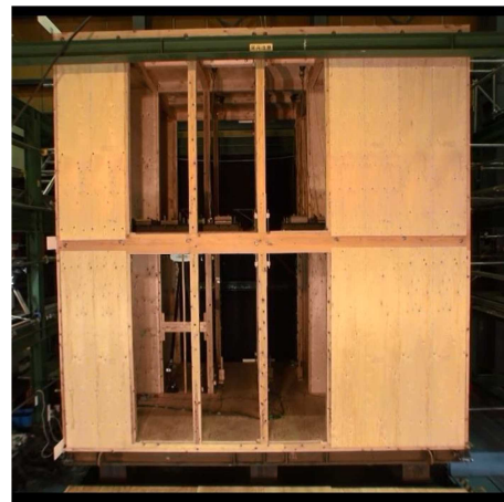
<制震棟試験体>
